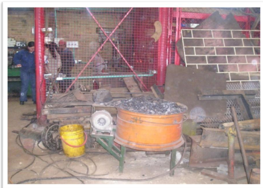
Foto No 2. Residuos sólidos como viruta y otros metales obstruyendo zonas de trabajo
